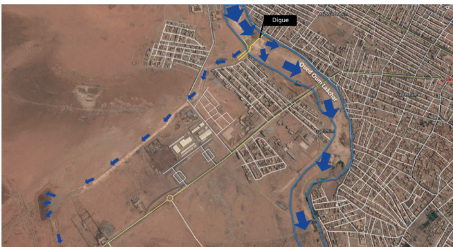
Figure 6: Illustration des chemins d'écoulement empruntés par les eaux d'inondation via l'oued Oum Laachar à Guelmim. (Source: Targa-AIDE)
